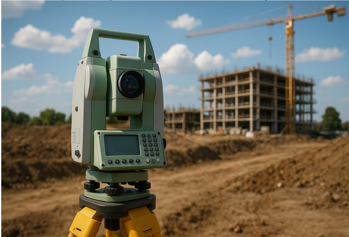
Figura 6 - Exemplo de Levantamento Convencional com Estação Total
