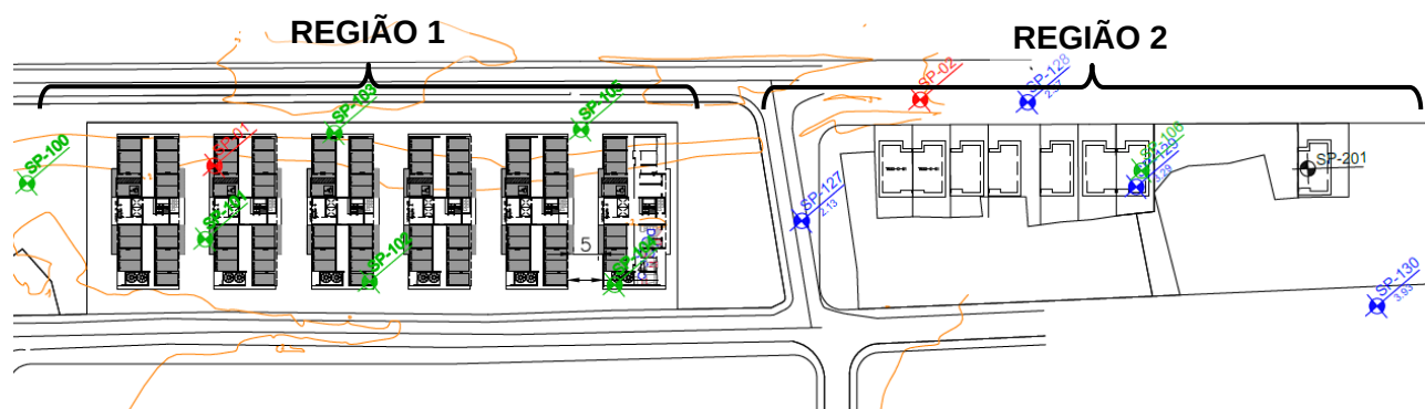
Figura 2 – Planta das regiões 1 e 2 e locação das sondagens.
